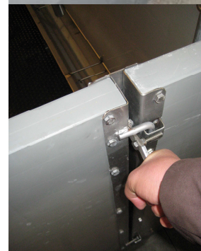
Öffnungsmechanismus mit Hebelgriff
