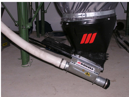
Staubfreie Aufnahme-Einheit für Förderspiralen an KoSa® - Silosäcke
